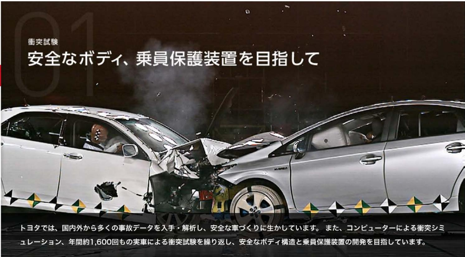
トヨタでは、国内外から多くの事故データを入手・解析し、安全な車づくりに生かしています。また、コンピューターによる衝突シミュレーション、年間約1,600回もの実車による衝突試験を繰り返し、安全なボディ構造と乗員保護装置の開発を目指しています。
